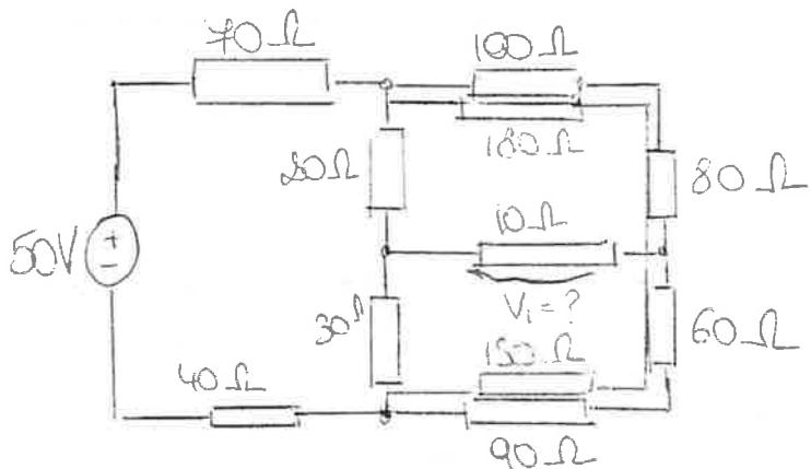
$$\textcircled{1} \text{ Zwei Serie: } R_1 = 100\Omega + 80\Omega = 180\Omega$$
