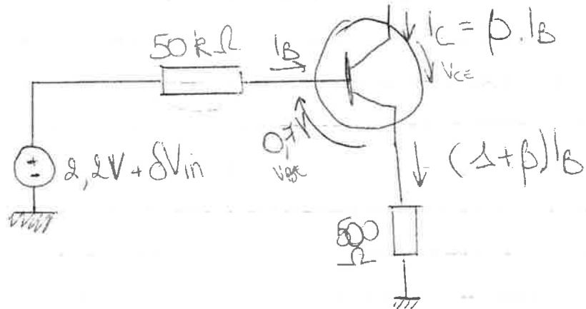
$$\text{Oplossing: 1) } 12,2 \text{ V} + \delta V_{in} = 50 \text{ k}\Omega \cdot I_B + 0,7 \text{ V} + 500 \frac{\text{V}}{\text{A}} \cdot 200 \cdot I_B$$
